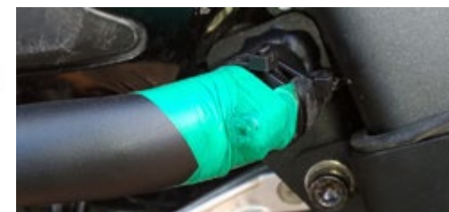
Compressore 12 V con vari cablaggi fra cui la presa diretta alla batteria (senza fusibile dedicato) e senza chiusura stagna. Monto questo sulla mia moto e per evitare che lo spinotto si ossidi l'ho rivestito di nastro isolante (verde) e di scotch duct tape che rimuovo all'occorrenza. Consigliato!
