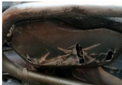
Patagonia 2018. Copri valvole della R1200GS LC Adventure rotto su tre punti e riparato con sette euro di componenti da cucina.
